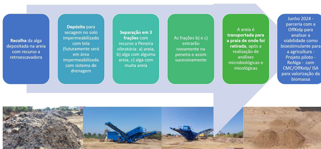
Figura 6 — Procedimento adotado pela Câmara Municipal de Cascais para a remoção da areia da biomassa recolhida.
