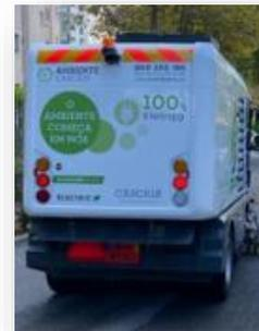
Em 2023 adquiriu-se mais uma varredoura mecânica de 4 m<sup>3</sup>, totalmente elétrica.
